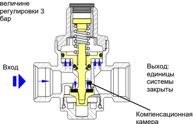
Когда все обслуживаемые единицы системы закрыты, давление на выходе повышается, толкая поршень редуктора вниз. Тем самым затвор закрывает проходное сечение редуктора, поддерживая давление постоянным на величине настройки, выставленной на пружину; минимальная разница давления, присутствующая на границе затвора, позволяет идеальное закрытие последнего.
