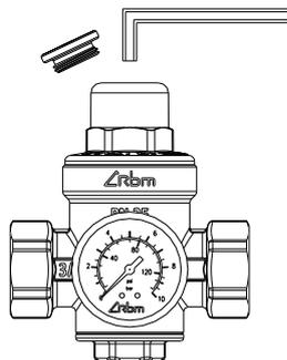
Окончательная настройка редуктора давления должна осуществляться на полностью заполненном гидравлическом контуре со всеми единицами системы в закрытом положении, в противном случае могут быть получены искаженные значения вследствие того, что во время вероятной подачи и распределения жидкости давление на выходе снижается в соответствии с требуемым количеством потока.
