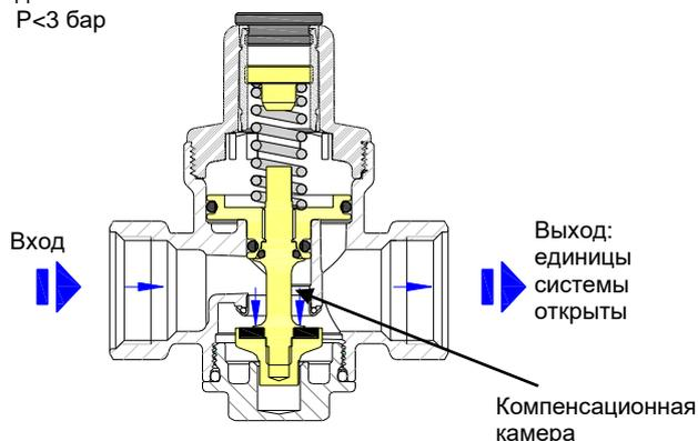
При открывании единиц системы на выходе давление, оказываемое на поршень, уменьшается в пользу силы, оказываемой пружиной на затвор, позволяя ему открываться с последующим прохождением жидкости. Чем выше запрос воды со стороны сети устройств, тем ниже давление на поршень и тем большим будет прохождение воды.
