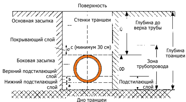
Рис. 3 Устройство траншеи
